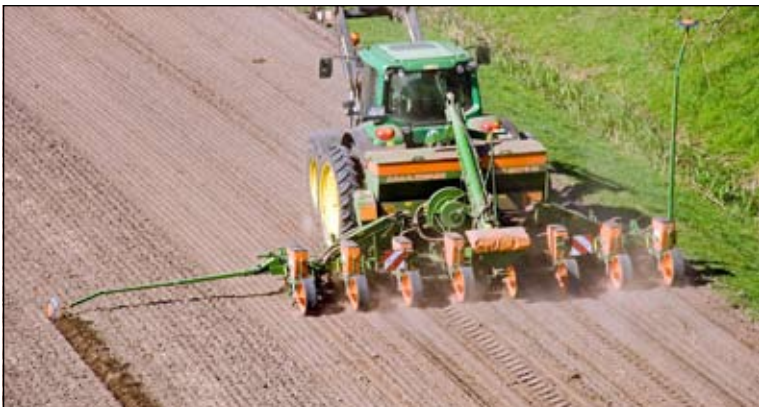
Für das Legen der Maissaat verfügt das Lohnunternehmen über vier Einzelkornsämaschinen, drei davon in Mulchsaatausführung.
